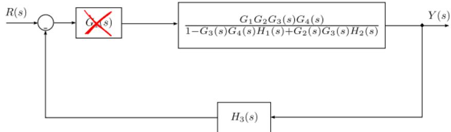
$$\frac{\frac{G_1 G_2 G_3 G_4}{1 - G_3 G_4 H_1 + G_2 G_3 H_2}}{1 + H_3 \left( \frac{G_1 G_2 G_3 G_4}{1 - G_3 G_4 H_1 + G_2 G_3 H_2} \right)} \Rightarrow Y(s) = \frac{G_1 G_2 G_3 G_4}{1 - G_3 G_4 H_1 + G_2 G_3 H_2 + H_3 G_1 G_2 G_3 G_4} X(s)$$
