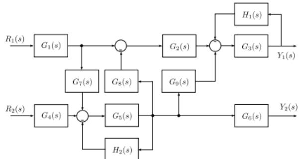
$$\frac{Y_1}{R_2} = \frac{G_2 G_3 G_4 G_5 G_8 + G_3 G_4 G_5 G_9}{1 + G_3 H_1 + G_5 H_2 + G_3 G_5 H_1 H_2} //$$
